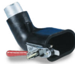
Çift egzozlu araçlar için oval lastik nozul. Manuel kilitleme kolu ve emisyon ölçüm giriş ağızı Ø20 mm
